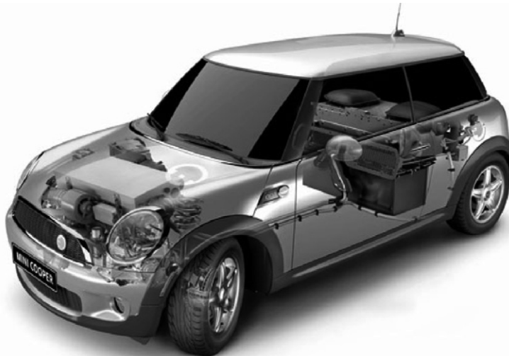
Figure 22.39 MINI E: system layout.
