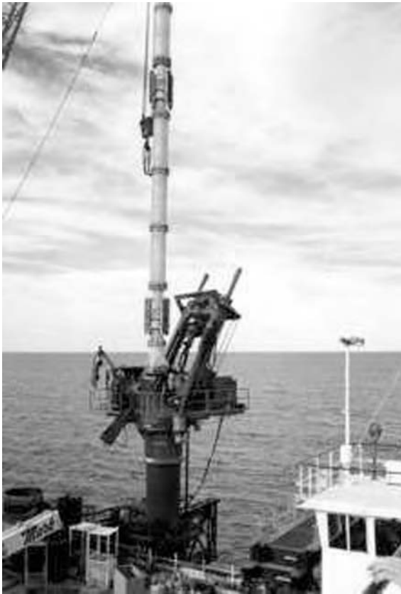
Figure 3.35 Wirth PBA pile top rig (courtesy Wirth Maschinen und Bohrgerate-Fabrik GmbH).
